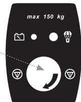
Ligue novamente o suspensor girando o botão de parada de emergência no sentido da seta até ele saltar para fora. Pressione duas vezes o controle manual e o suspensor estará pronto para operação.
